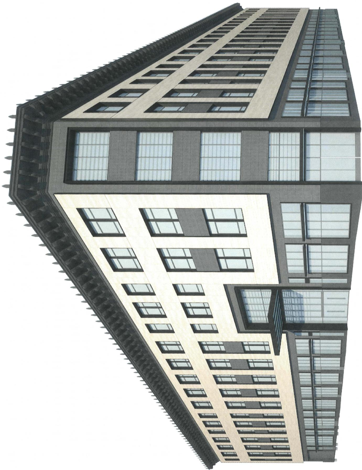
**CORNER SCHEME 6.4 - ORIGINAL CORNER SCHEME WITH EDGES OF TERRA COTTA PULLED BACK - WINDOW WALL**
