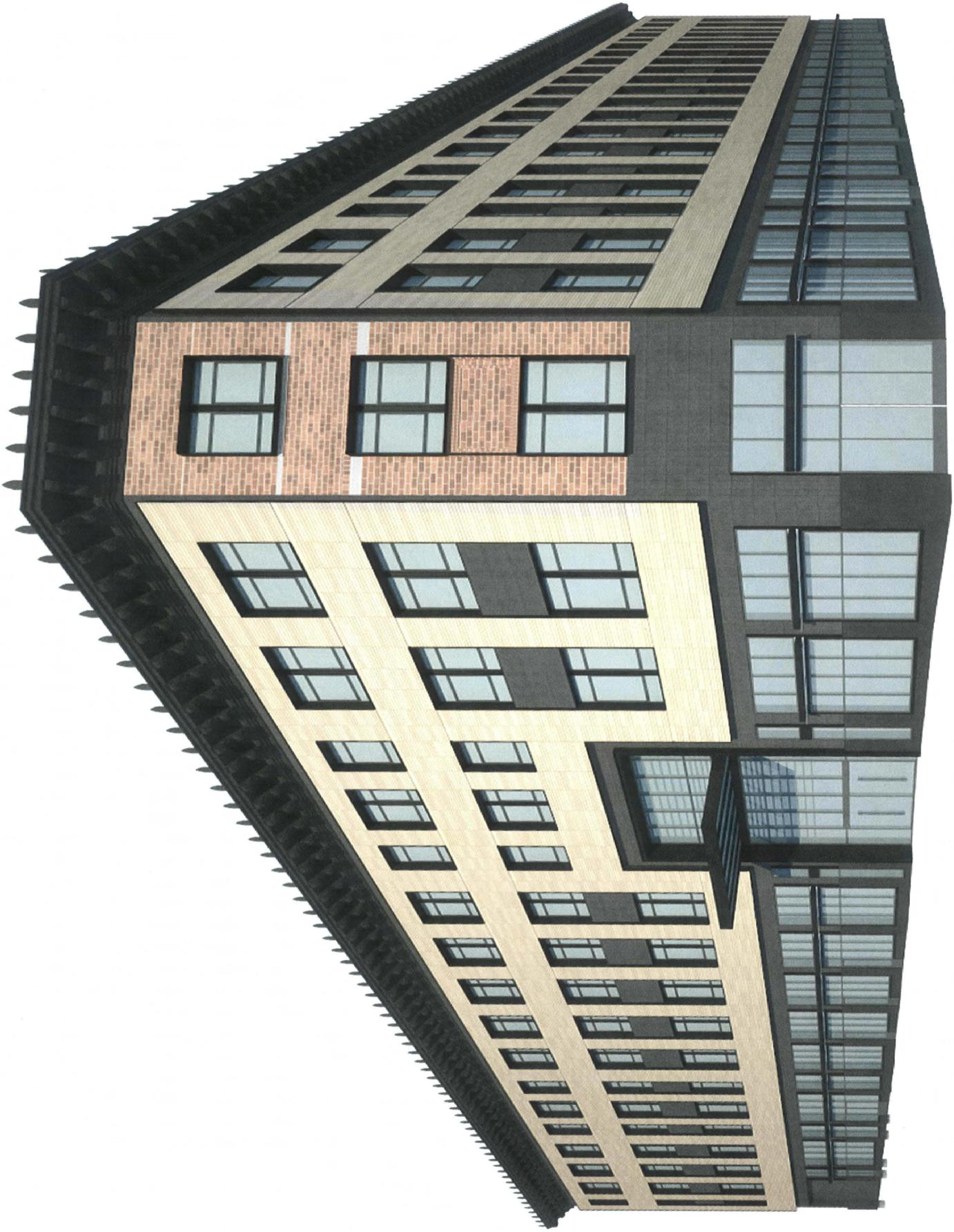
CORNER SCHEME 5- BRICK REVEALED AT CORNER
