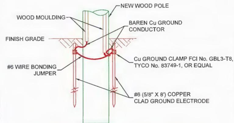
**GROUND ROD INSTALLATION FOR UTILITY POLES GND-1**
